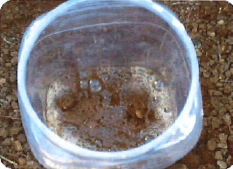
*Figure 5 : Test d'un échantillon de terre au vinaigre blanc, réaction du vinaigre*
